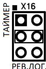
Таймер обеспечивает автоматическое закрытие шлагбаума, спустя установленное время после открытия ( заводская настройка – 15 секунд).
